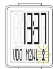
**Сенсор** в моделях M1 WL и M2 WL поддерживает режим ожидания. В случае перерыва **сенсор** остается активным в течение 2 ч. Это можно определить по мигающему значку в виде антенны на дисплее.
